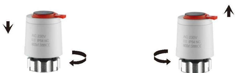
Schrauben Sie den Stellantrieb im Uhrzeigersinn auf das Ventil. Mit der Hand festziehen. Schließen Sie den Strom 3 – 5 Minuten lang an. Entfernen Sie das rote Teil.
